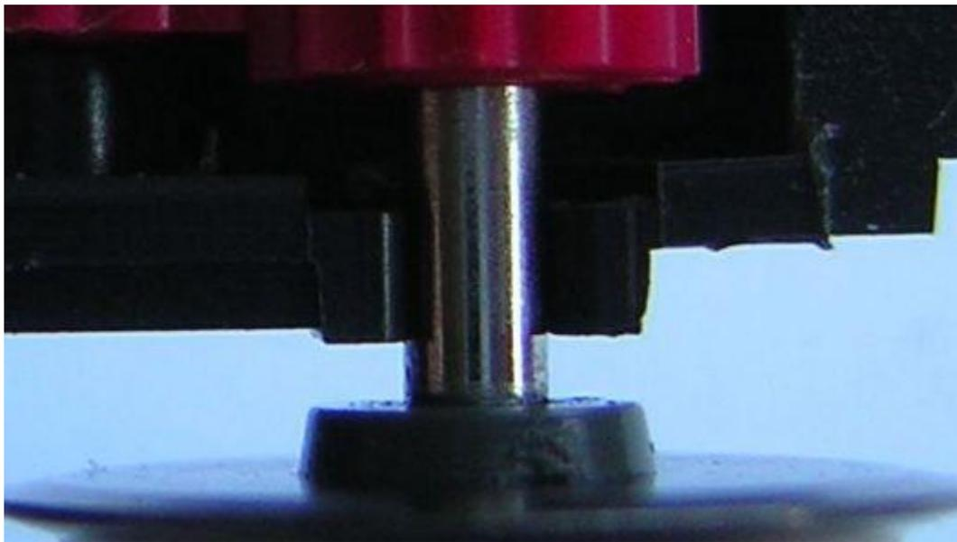
Achsenlager zum Einlegen der Achsen (meist Plastik): Öl (LaBelle 108, bei Metall-Getrieben LaBelle 102)
