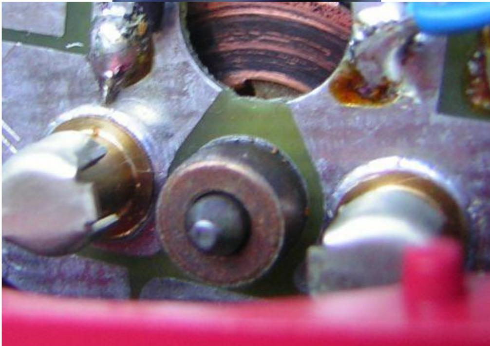
Umfassende Achsenlager (meist Metall, FLM, Märklin), Motorwellenlagerung im Motorschild (FLM, Lima und Märklin): Öl (LaBelle 101)
